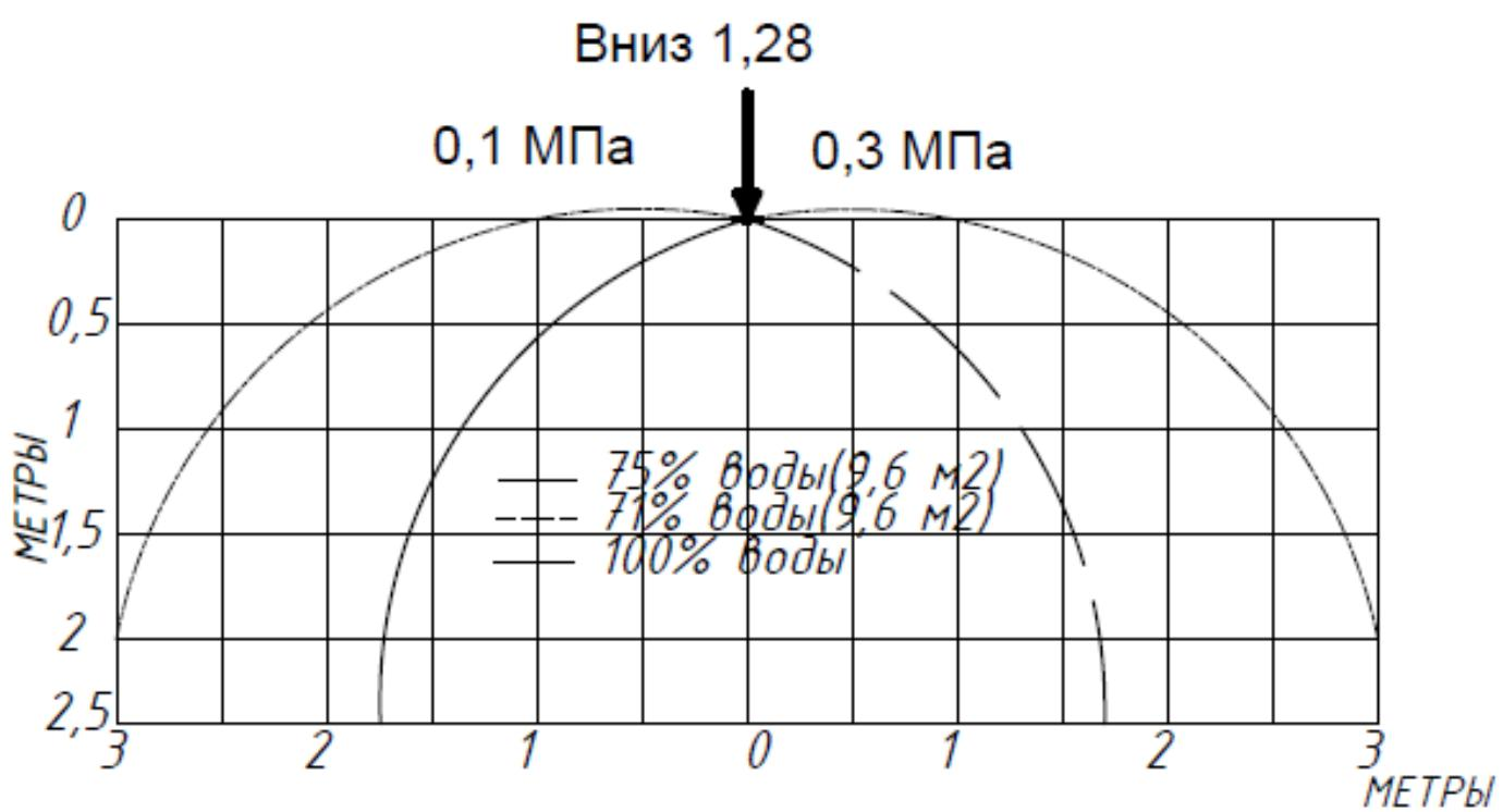
**Графики зависимости интенсивности орошения от давления для оросителей специальных при высоте установки 2,5 м и площади 9,6 м<sup>2</sup>**
